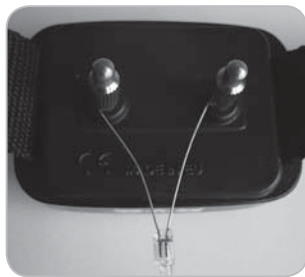
Проверка разряда с использованием тестовой лампы
